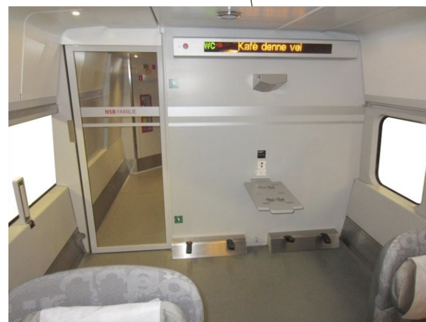
Strømuttak og alarmknapp
